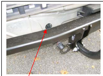
Kabeldurchführung, Ansicht von Außen
