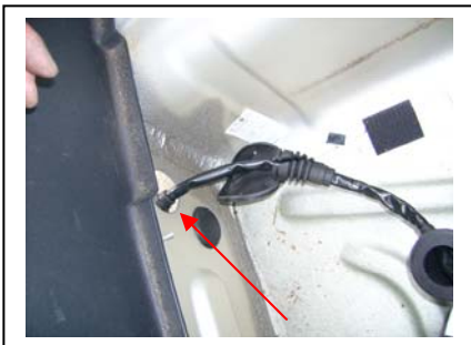
Kabeldurchführung, Ansicht von Innen
