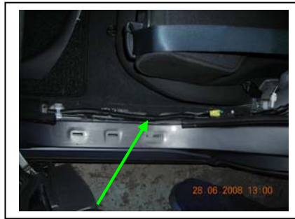
Verlegung Kabel Stromversorgung Modul
